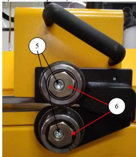
Зазор между режущими кромками должен быть таков, чтобы можно было прокручивать один ролик по отношению к другому с небольшим усилием.
