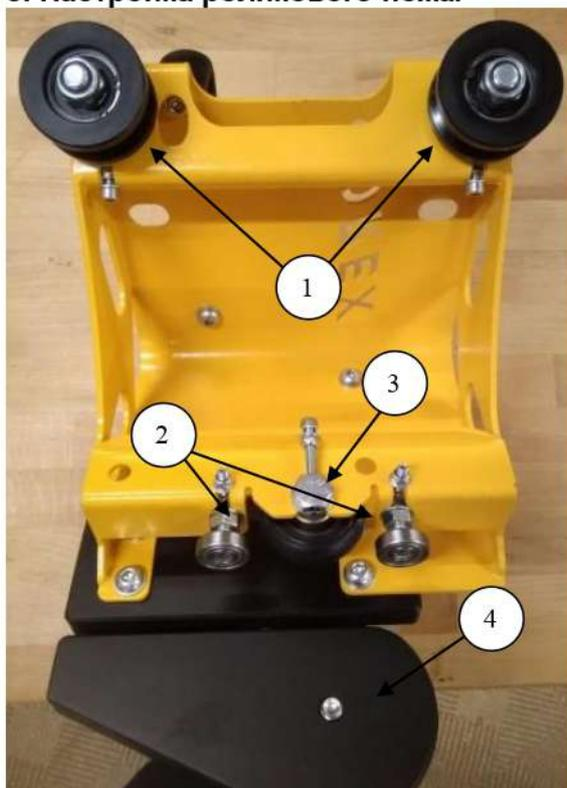
Настройка положения ножа на направляющей прижимной балки выполняется за счёт регулировки положения верхних (1) и нижних опорных роликов (2, 3). Зажатый в станке лист должен размещаться по центру паза роликового блока (4).
