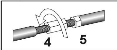
контргайку (5) и поворотом стяжной шпильки. (4) добейтесь нужного результата.
