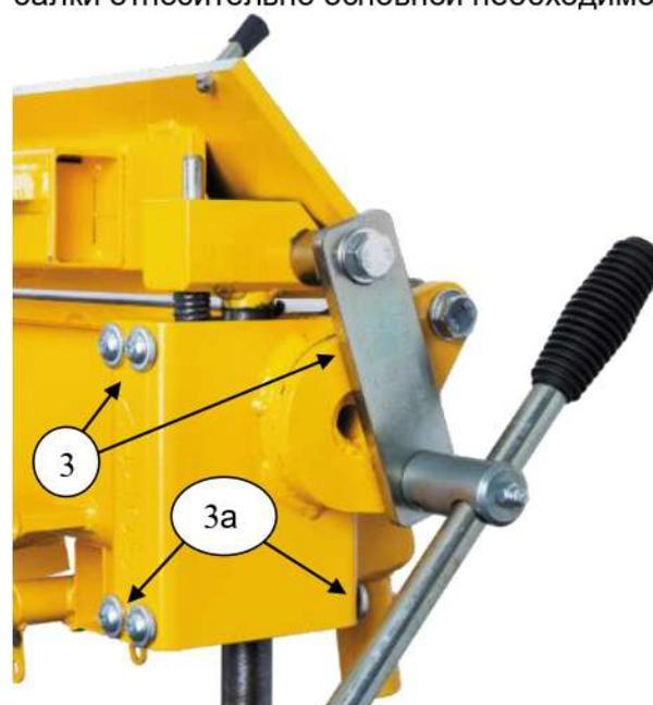
необходимо ослабить пару верхних болтов (3) прижимной станции и затянуть пару верхних болтов с противоположной стороны. Основная балка должна выглядывать из под прижимной на 0,2-0,3 мм у края станка. Наклон прижимной балки по отношению к основной регулируется парами нижних винтов (3а) прижимной станции таким же образом. По центру прижимная балка должна быть заподлицо с основной. Для обеспечения необходимого прогиба на регулировочной тяге прижимной балки ослабьте
