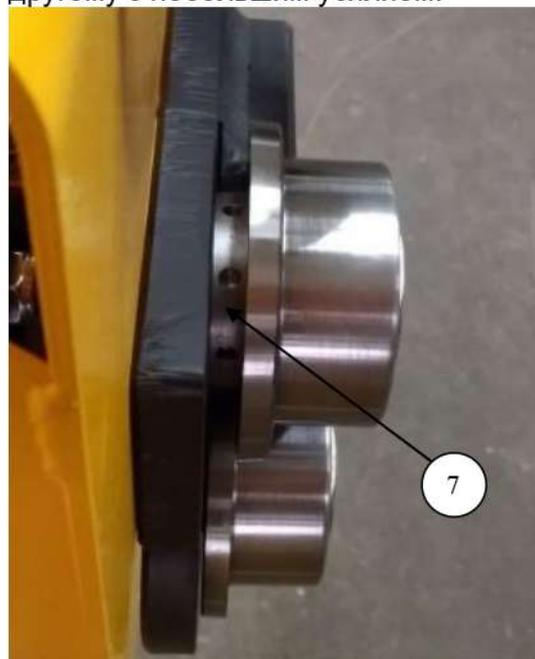
Для регулировки зазора ослабьте винты (5) и поверните регулировочное кольцо (7) При резке мягкого материала, относительно загрязненного лезвия ножа необходимо обработать керосином или масляной эмульсией. Это предотвращает прилипание частиц металла к лезвиям ножа и их повреждение.
