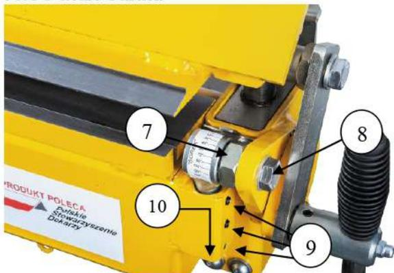
Для уменьшения зазора между основной и гибочной балкой ослабьте болт (8) и поверните эксцентрик (7). Затяните болт (8). Для регулировки положения балки по высоте ослабьте шестигранником установочные винты (9) и поверните шестигранником на 8 мм винт (10). После установки высоты затяните винты (9). Радиус загиба листа можно уменьшить (заострить кромку детали) или увеличить (смягчить кромку детали) регулируя высоту гибочной балки. Чем ниже уровень гибочной балки, тем больше радиус загиба.
